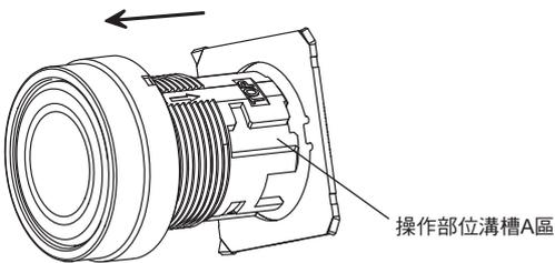
②若止迴部件被設置於下圖所示的位置，即可開始旋轉，直到到達操作部位溝槽B的位置為止。
