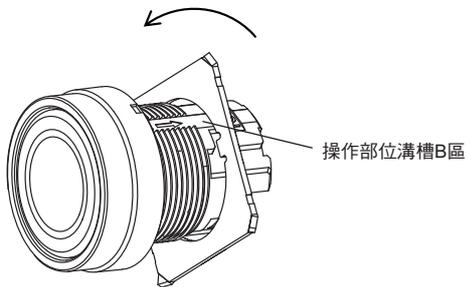
③若止迴部件被設置於下圖所示的位置，請將金具朝箭頭方向移動。
