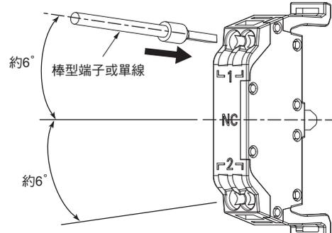
亮燈組件、開關組件(2接點)和上圖中的開關組件(1接點)的配線角度相同。
