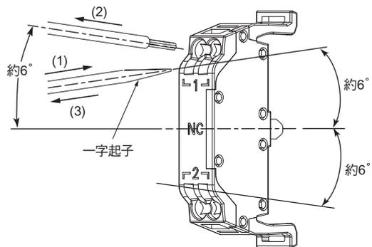
亮燈組件、開關組件(2接點)的配線角度和起子角度和上圖所示的開關組件(1接點)相同。
