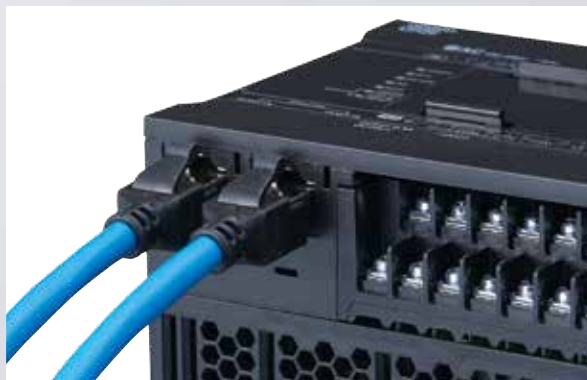
2個乙太網路連接埠（內建L2交換式集線器功能）
