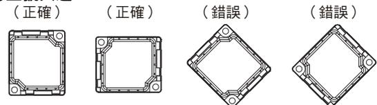
薄板產品(39-RS10型、E39-RS11型)為貼紙。請撕下離型紙後，黏貼在平坦的安裝面。此外，若安裝面有碎屑或髒污，會減弱黏著力導致薄板彎曲，可能造成誤作動。
