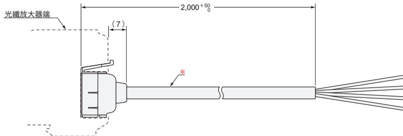
\* 導線  $\phi 4/4$ 芯/標準2m (導體截面積:  $0.2\text{mm}^2$  (AWG24)/絕緣體直徑:  $\phi 1.1\text{mm}$ )
