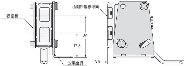
\* 調整旋鈕時，從安裝金具的橫截面突出0.8mm。
