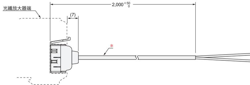
\* 導線  $\phi 4/2$ 芯/標準2m (導體截面積:  $0.2\text{mm}^2$  (AWG24)/絕緣體直徑:  $\phi 1.1\text{mm}$ )
