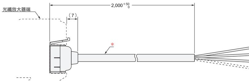
\* E3X-CN11: 導線 φ4/3芯/標準2m (導體截面積: 0.2mm<sup>2</sup> (AWG24) /絕緣體直徑: φ 1.1mm)
