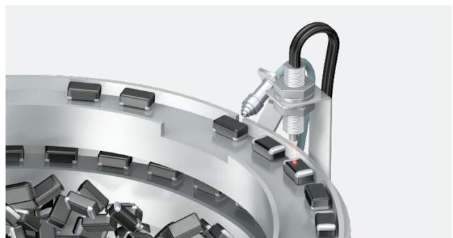
輸出晶片正反面檢測時的空氣吹出
