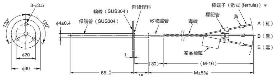
\* 保護管為直管結構，無法彎曲使用。
