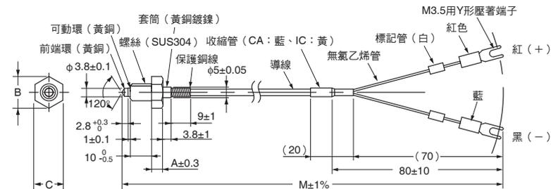
內部構造 (圖示E52-CA1DY型的情形。)
