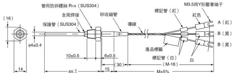
\* 保護管為直管結構，無法彎曲使用。
