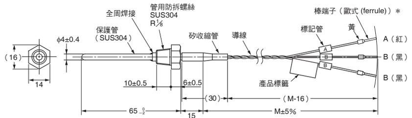
\* 保護管為直管結構，無法彎曲使用。
