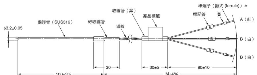
\* 1. 保護管為直管結構，無法彎曲使用。
