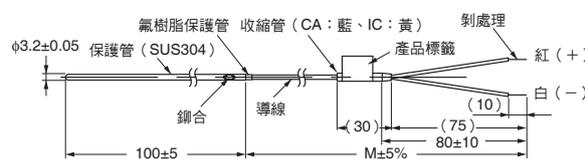
1. 從前端到末端使用1條熱電偶線。
