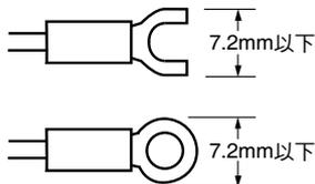
在E5DC型中使用壓接端子時，請使用附有絕緣包覆的壓接端子。若直接使用裸壓接端子，可能導致上下端子間短路。使用裸壓接端子時，請以具絕緣功能的套管加以覆蓋。此外，請實施套管的固定措施，以免套管脫落。
