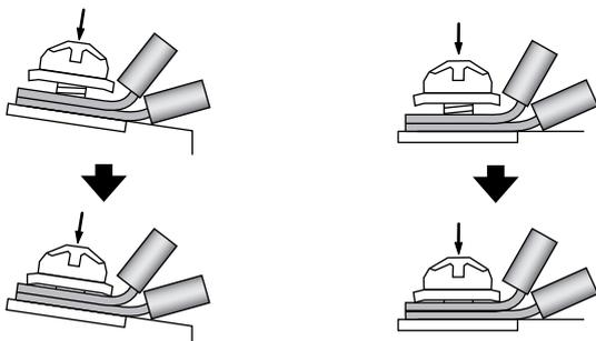
因此部分壓接端子若壓接部位較大時，應如圖所示事先進行彎曲加工，並慢慢鎖緊端子螺絲，使其與端子台的端子面保持垂直。
