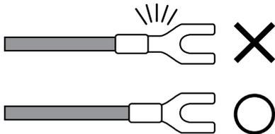
建議使用的E5DC型附絕緣包覆壓接端子
