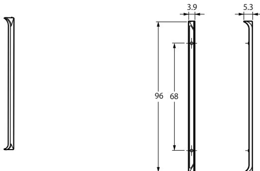
將E5DC型/E5DC-B型安裝於盤面時，請用來遮蔽本體與面板之間的縫隙。
