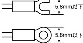
1個端子上最多可連接2個附絕緣包覆的壓著端子，但無法使用絕緣包覆徑較大者。請參閱下圖，選擇適合用來鎖合的壓接端子。(E5CC-U型除外)
