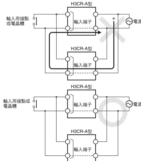
此外，即使相位一致，仍無法如下圖所示進行電源開關的獨立操作。（單方的計時器電源開關為ON時，若將輸入切換成ON，則雙方的計時器皆會動作。）
