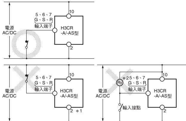
\* 1. 電源端子2為輸入信號的共用端子。若將端子10設為共同端子會使內部回路損壞，敬請注意。
