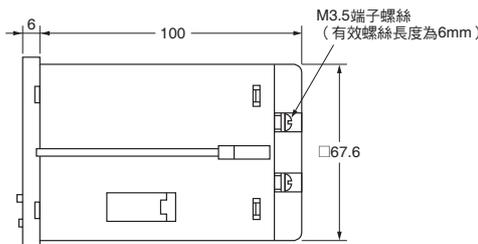
註: 端子使用M3.5螺絲。(有效螺絲長度為6mm)
