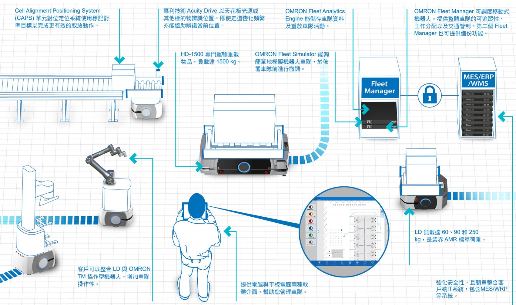
機器人提供性能價值。OMRON 移動式機器人可處理基礎運輸、交付以及路徑規畫，使員工可執行更高附加價值的工作。
