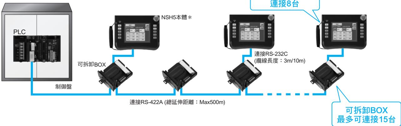
\* 將NSH5從可拆卸BOX上拆卸下來時，請務必事先將可拆卸BOX的電源鍵設為OFF之後再行拆卸。
