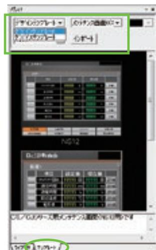
樣板由多個所構成。將縮圖拖至畫面後，即可將多張畫面貼上畫面。
