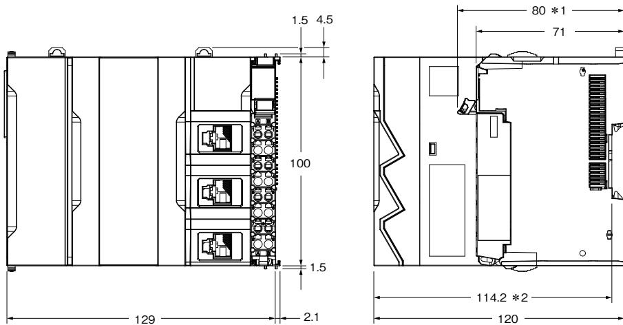
\*1. 從端子台鎖定桿到CPU單元背面的尺寸。
