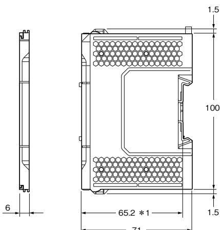
\*1. 從DIN鋁軌的連接表面到端蓋前表面的尺寸。
