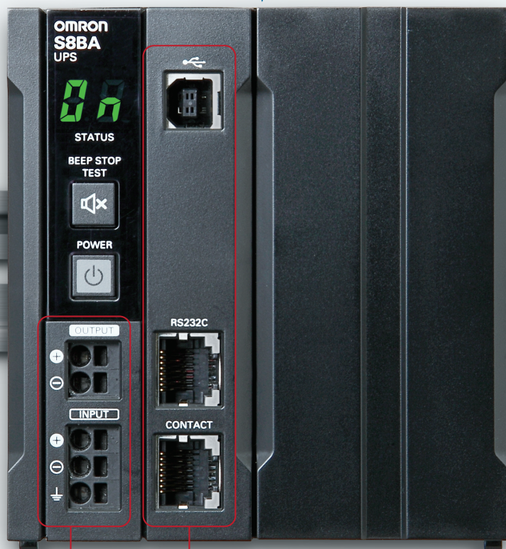
不斷電系統(UPS) S8BA-24D24D120LF型(120W)
