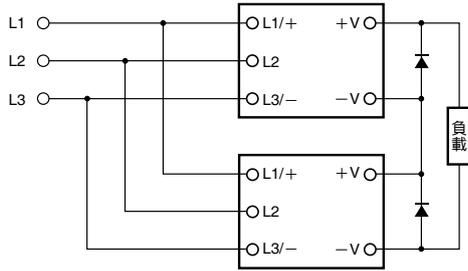
註1. 負載短路時，會在產品內部產生逆電壓。因產品有可能劣化、損壞，請如圖所示連接二極體。另外，選擇二極體的規格標準如下。
