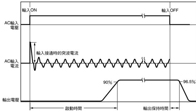
註. 並聯操作、備用操作時會流過倍於平常的突波電流。請充分確認保險絲的熔斷特性以及斷路器的動作特性後，選擇適當的保險絲。以避免在發生突波電流時，外部保險絲未熔斷或斷路器未動作的情况。
