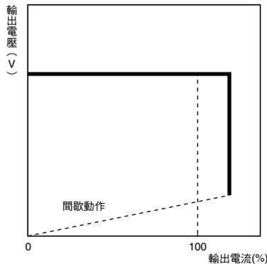
註1. 若持續在短路及過電流的狀態下使用，在極少數的情況下，內部配件會劣化、損壞。使用前請先確認 $I_{out}>100\%$ 指示燈未亮燈，或 $I_{out}>100\%$ 訊號輸出為OFF。
