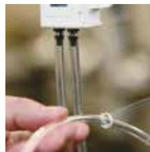
將感測頭設置於無塵工作站外，並將 Hi 側管路插入站內（正壓側）。
