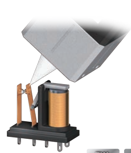
繼電器接點部位動作確認
