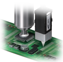
SMT置件的Z軸調整
