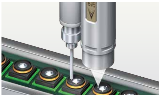
測量塗布後的樹脂高度
