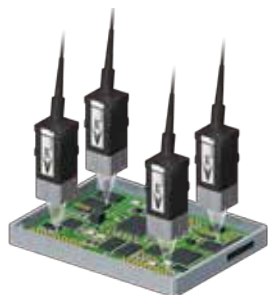
量測 ECU 基板的組裝狀態
