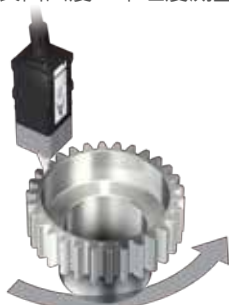
旋轉加工配件的表面曲度、平坦度測量
