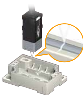
組裝零件貼片材料外觀確認
