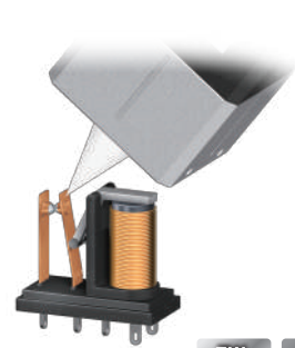
繼電器接點部位動作確認
