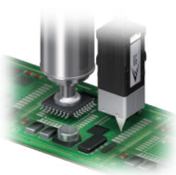
SMT置件的Z軸調整
