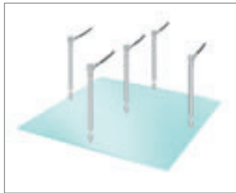
測量玻璃的彎曲 選擇測量力較輕的機型，即可在不損壞工件的前提下，進行高精度的測量。
