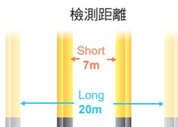
設定最長20m\*的Long模式時，透過切換至Short模式（7m），即可降低與近距離感測器相互干擾的程度。
