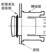
防水襯墊有方向性。如右圖所示，請以較寬的一端為面板側進行安裝。為確保防水性，安裝轉接器請以一字起子等確實壓入。
