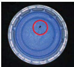
對於難以分辨的損傷，亦可透過彩色濾鏡改善對比度而檢測
