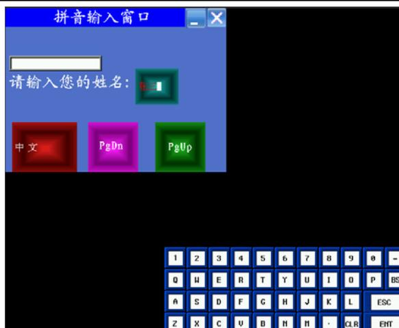
補充：①. 如果拼音輸入過程中需要修改，可用鍵盤上的功能鍵的退格或清除來操作。
