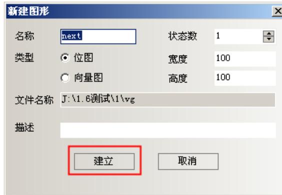
2. 點擊【建立】，彈出如圖所示的編輯方塊，在黑色的編輯方塊裡點一下右鍵【載入點陣圖】。
