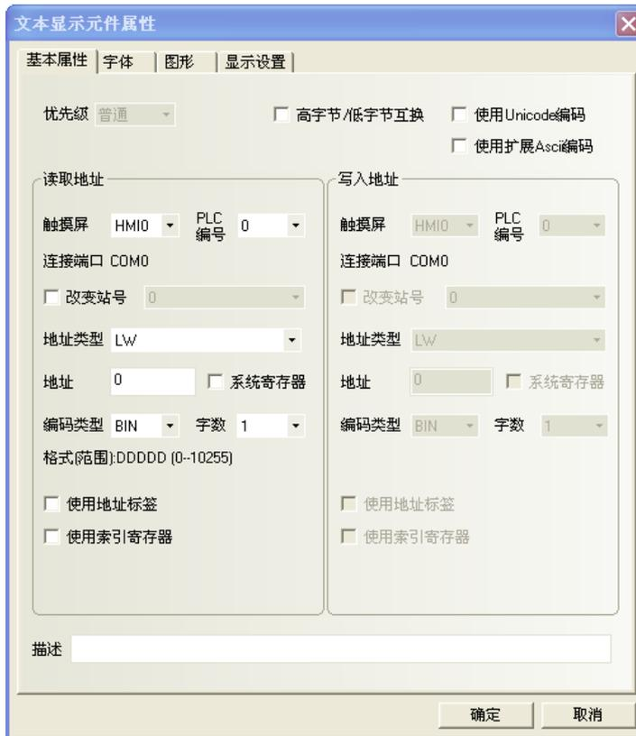
**高位元組/低位元組互換**：同一個位元組，高位和低位交換位置，如圖所示：
