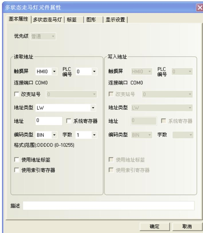
2. 點擊[多狀態走馬燈]頁：進行移動方式、狀態數和步長、速度的設置。
