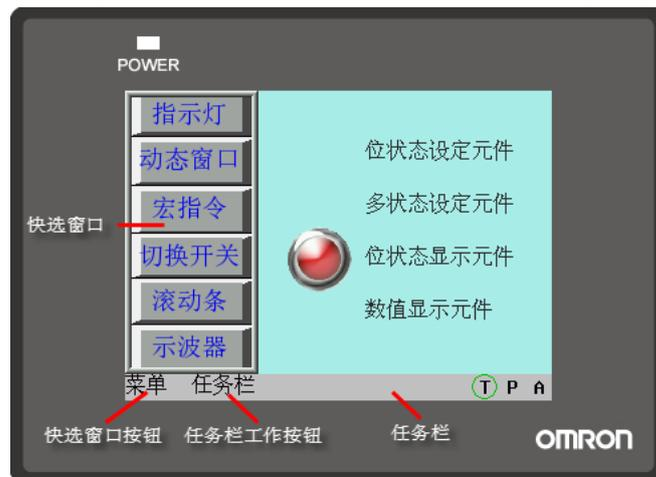
工作列最多可同時包含 16 個窗口圖示。按兩下最小化圖示可將對應的彈出窗口最小化，再點擊一下這個圖示就可以恢復窗口到原來的狀態了。當一個彈出窗口含有[最小化窗口]和[窗口控制條]功能鍵時就可以把該窗口最小化到工作列上了。詳情請參閱[3-7-2 功能鍵]。
