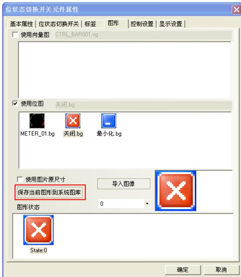
2. 進入【工程文件窗口】下面的【圖庫】，選中當前圖形，點擊右鍵【保存圖形到系統圖庫】。
