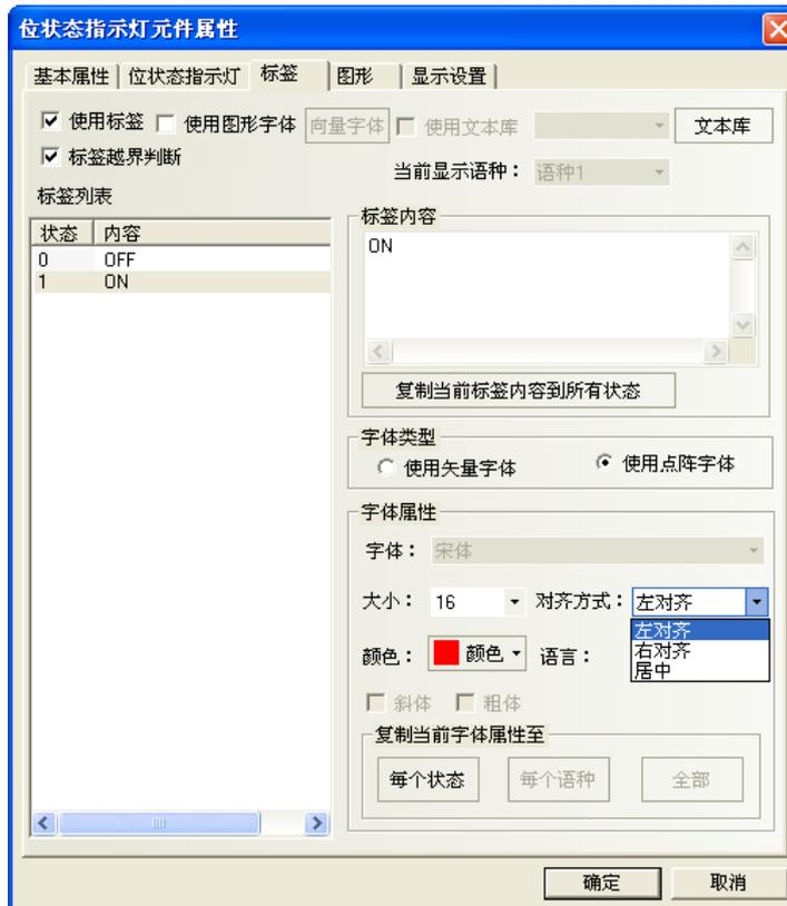
**狀態**：當該燈的狀態為 0 時，將顯示文字 OFF；狀態為 1 時，將顯示文字 ON。
