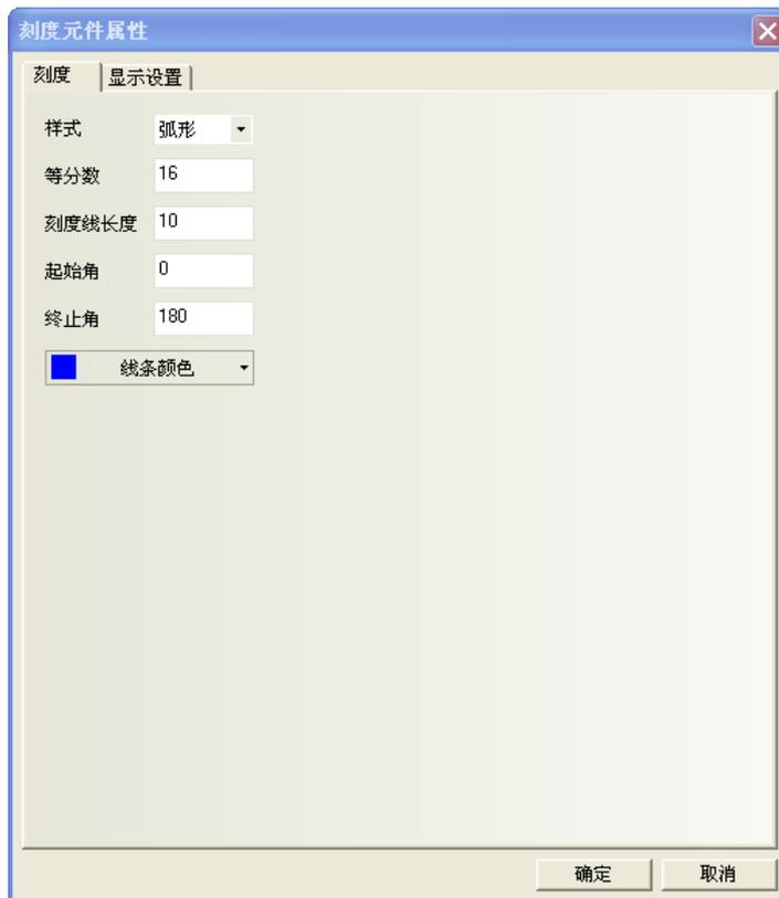
樣式：有四種樣式，垂直、水平、弧形、圓形。
