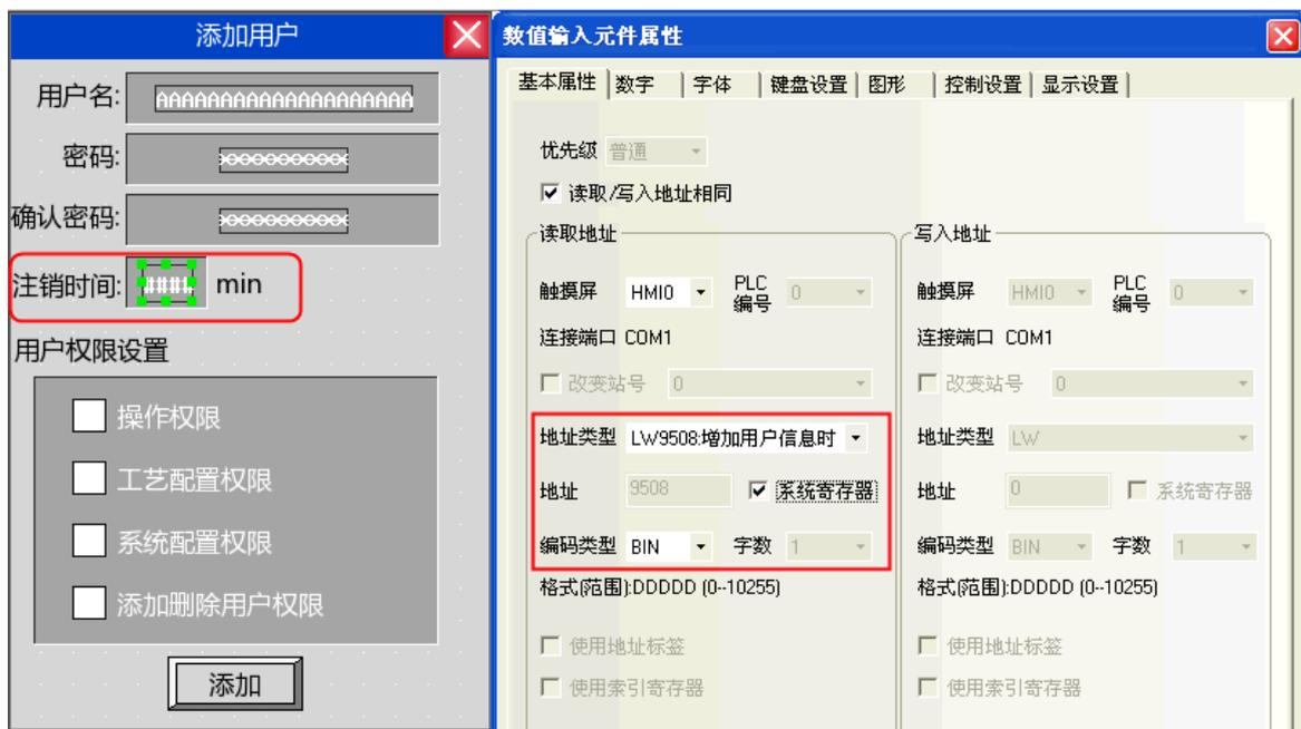
用戶權限分配：放置 4 個位狀態切換開關，地址分別為 LW. B 9506. 0、LW. B 9506. 1、LW. B 9506. 2、LW. B 9506. 3，開關類型為【切換開關】。
