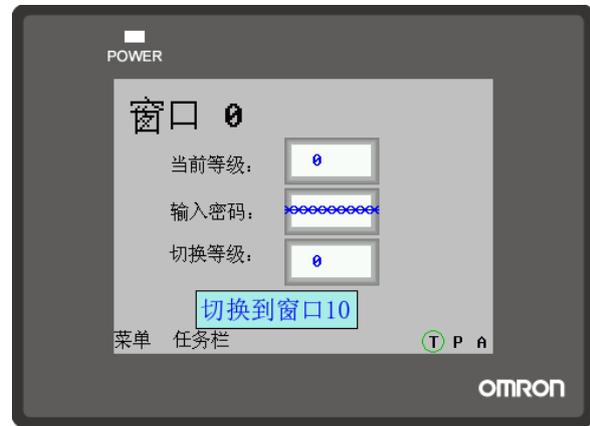
運用等級密碼合理的设计工程，給予每個操作員不同的操作權限，提高了應用系統的安全性能。
