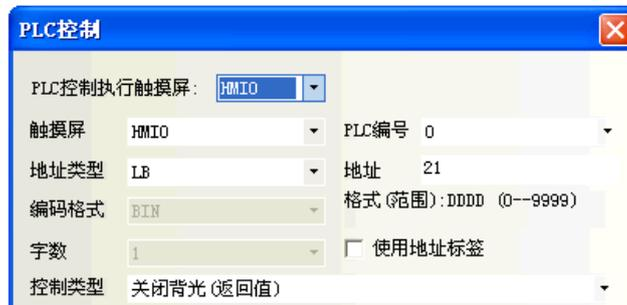
如圖所示，當 LB21 變為 ON 時，背光燈滅，同時 HMI 發出命令把 LB21 變為 OFF 狀態。當用戶觸控螢幕時，背光燈亮，LB21 為 OFF 狀態，即恢復到背光燈關閉前的狀態。
