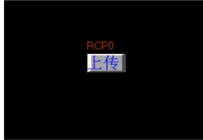
配方資料傳輸元件已經做好了，但是這個元件只是指出把 4X200 起始地址的五個字傳輸到配方記憶體上，沒有指出傳輸到配方記憶體的具體位置呀？這就是系統保留字 LW9000 的妙用了，我們將 LW9000 的值設為 300，按下傳輸元件按鈕，那麼我們就是把 4X200 為起始地址的五個字傳輸到配方記憶體 RW300 為起始地址的隨後五個字的位置上。如果我們又想把 4X200 為起始地址的五個字資料傳輸到 RW100，我們只需把 LW9000 的值設為 100，然後按下傳輸元件按鈕，就可完成傳輸。
