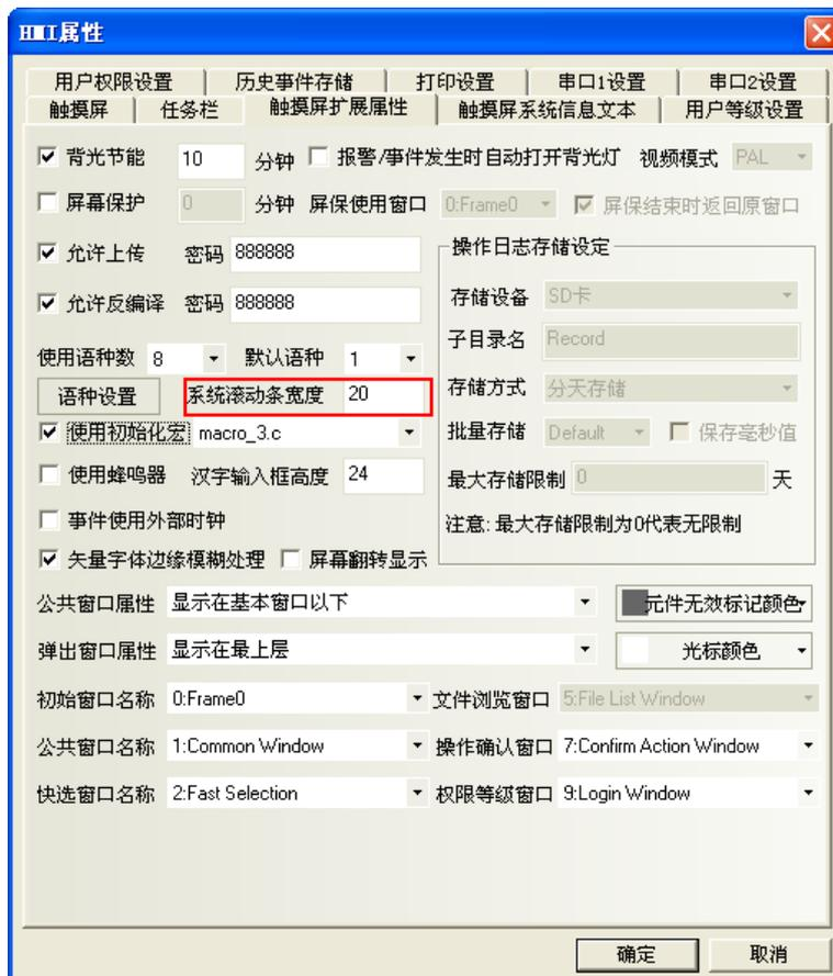
**使用初始化宏(巨集)**：當開機進入 HMI 應用程式模式時，系統將首先操作的巨集檔案；
