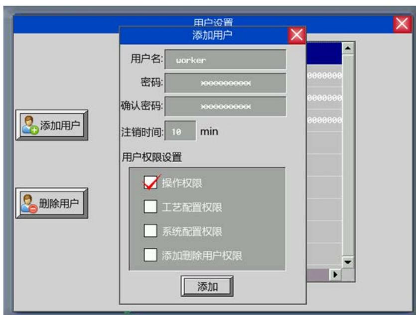
輸入要增加的用戶名，設置密碼並確認密碼，並為該用戶設置註銷時間以及分配用戶權限。設置好後點擊“增加”即完成增加用戶的操作。
