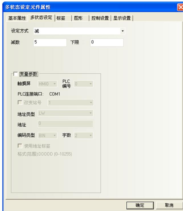
6. 我們怎麼知道當前是第幾組配方資料呢？LWO 顯示的數值是由什麼來控制呢？我們可以再做兩個多狀態設置元件，它們的地址均為 LW0，一個類型為減，一個類型為加，不需要任何的圖形。把類型為減的元件疊加在前面建立的類型也為減的地址 LW9000 的多狀態元件上，把類型為加的元件疊加在前面建立的類型也為加的地址為 LW9000 的多狀態元件上，這樣，我們翻閱配方資料的時候，LWO 的值也就跟著變動，且正好顯示當前是第幾組資料。如下圖所示：
