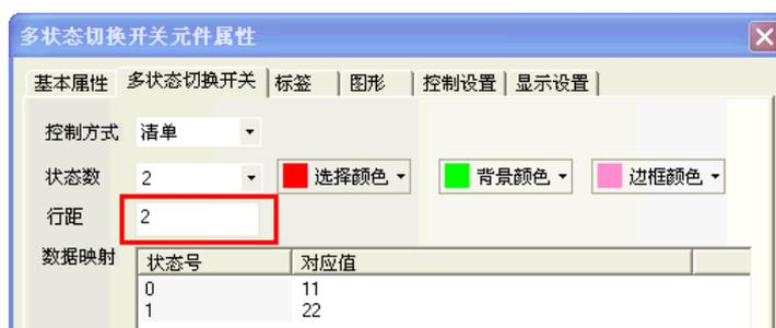
**對應值：**當讀取地址讀到的數值等於對應值內的某一值時，多狀態控制元件將顯示此值的狀態號對應的標籤和圖形。當切換到某一狀態號時，此狀態的對應值將被寫到寫入地址。
