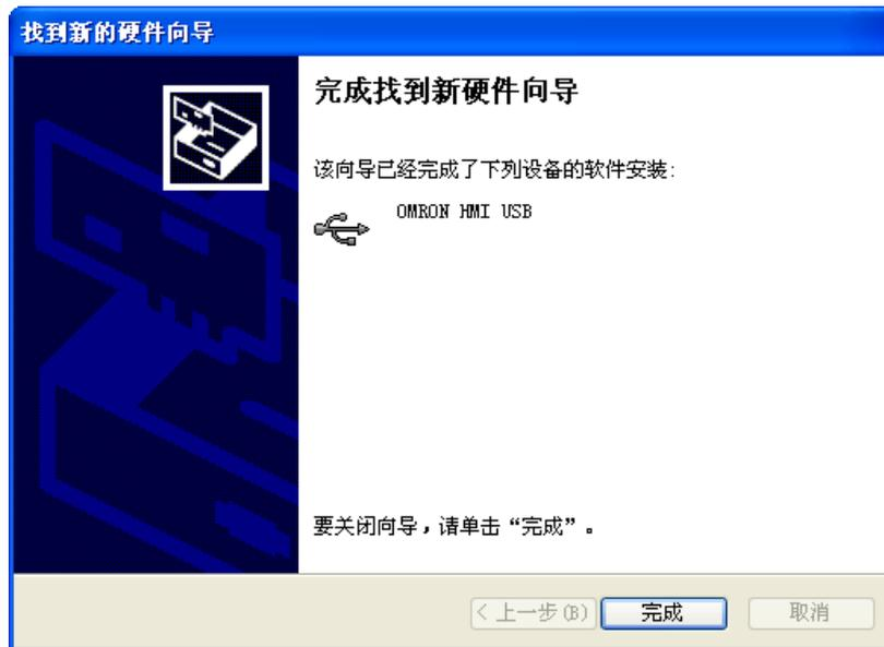
注意：HMI 後的指撥開關 1，2 都為 OFF 時，電腦才會出現“OMRON HMI USB”項目。以後採用 USB 來下載不需要進行其它設置，下載設備選擇 USB，確定，即可進行下載。
