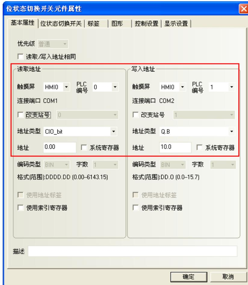
PLC 編號欄中可顯示所有可選用的 PLC 設備。
