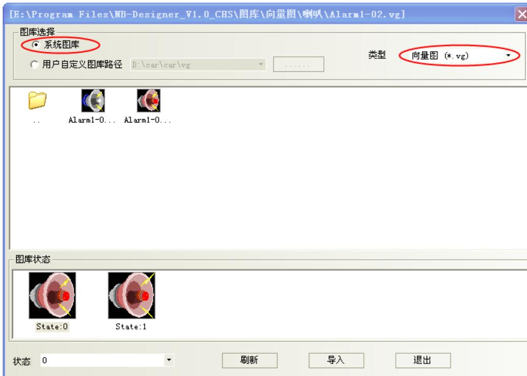
一個向量圖可包含 256 種狀態，向量圖有 2 種使用方式，一種是作為靜態向量圖使用，另一種則是表示各元件狀態與顯示變化圖形使用。例如利用多狀態顯示元件可設定最大 256 種圖形變化。
