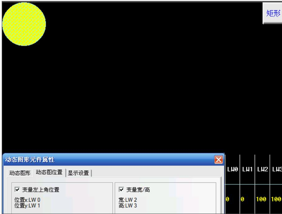
2. 動態矩形：地址為 LW0，左上角的位置為 LW0=50 (X 的值)，LW1=80 (Y 的值)，寬度 LW2=200，高度 LW3=100 效果如圖所示。
