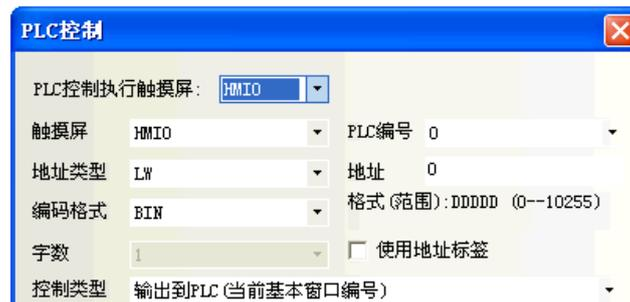
如圖，當有如上設置的一個 PLC 控制元件時，word 地址 LW0 中的值=當前基本窗口編號。
