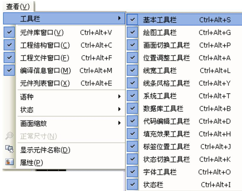
在功能表[查看]中的各個選項可以分別用來控制各種工具列的顯示與否，基本上每一個工具列的內容都可以在功能表中找到對應的內容。
