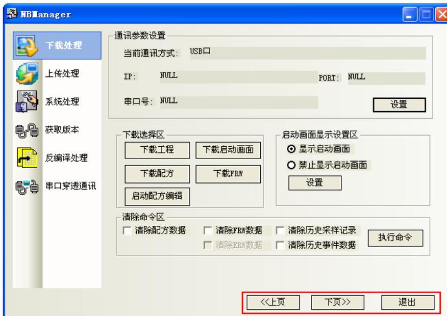
點擊【上頁】，【下頁】可以在下載、上傳、系統處理、獲取版本、反編譯處理和串口穿透通訊之間進行切換。
