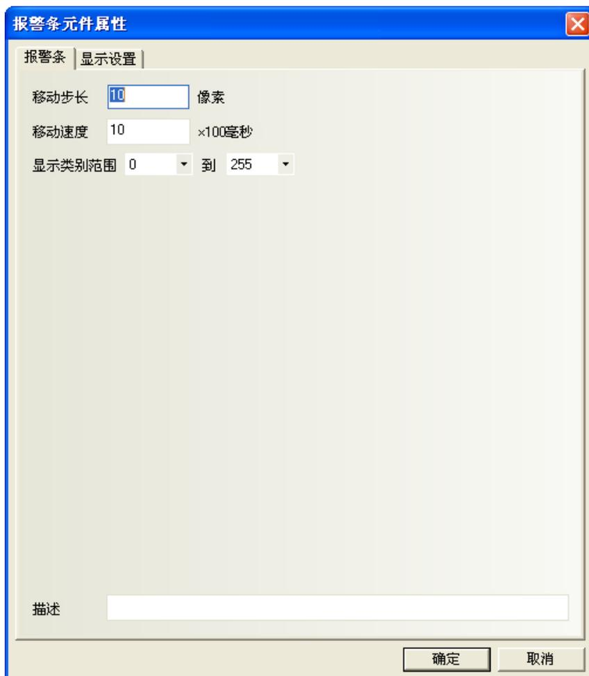
**移動步長：**單位為像素，設定每次移動的像素個數。移動步長數值越大，滾動顯示的速度就越快。數值在 1~255 之間。
