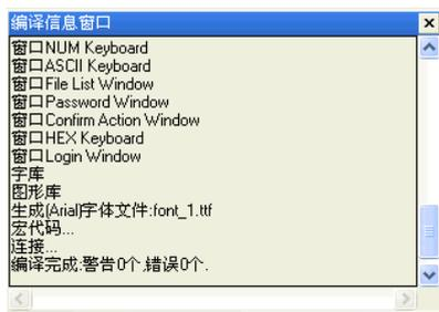
開啟工程時，編譯資訊窗口將顯示工程的載入資訊；
