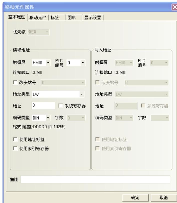
**讀取地址欄**：在PLC中控制移動圖形元件顯示的狀態、圖形和標籤等資訊的word首地址。
