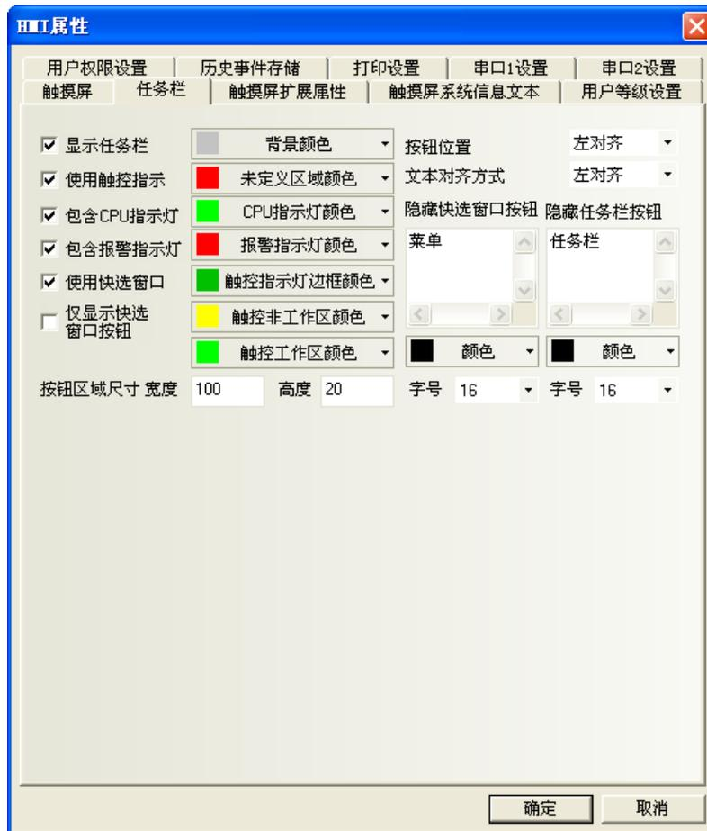
**顯示任務檔：**是否顯示任務檔工作列。如果選擇了顯示工作列，下圖的工作列將顯示的螢幕最下方。
