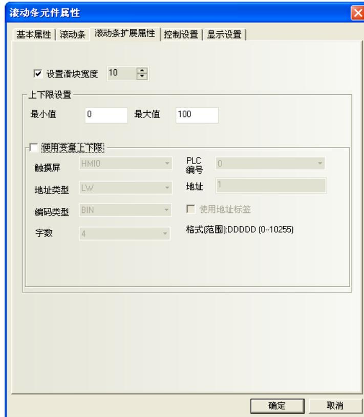
**設置滑塊寬度：**勾選表示手動設定滑塊的寬度，不勾選時滑塊寬度預設為 10（像素）。
