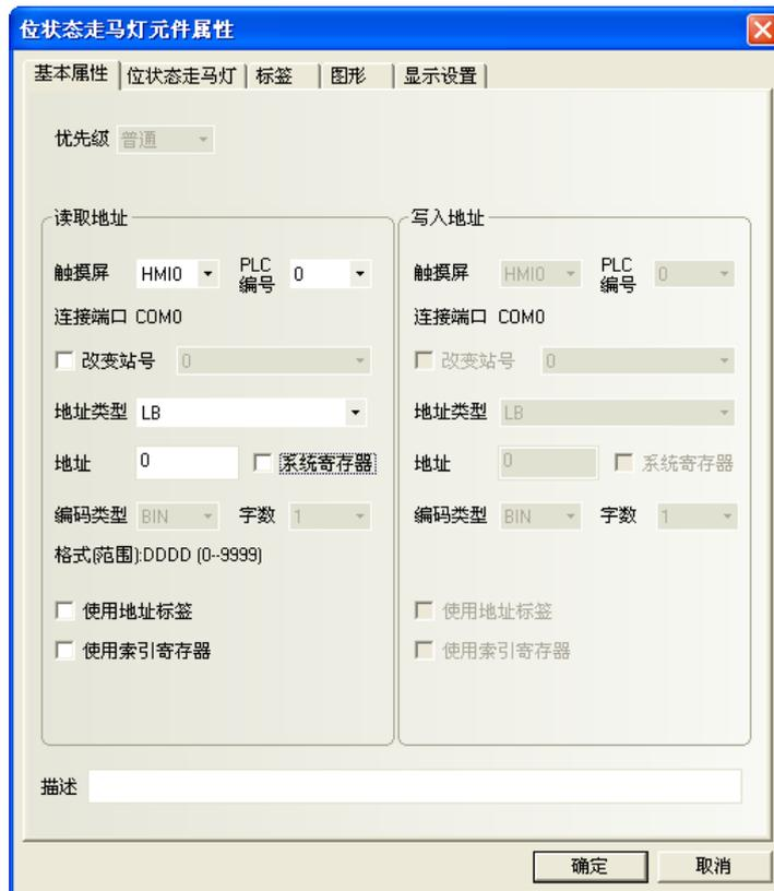
2. 點擊[位元狀態走馬燈]頁：進行移動方式和步長、速度的設置。
