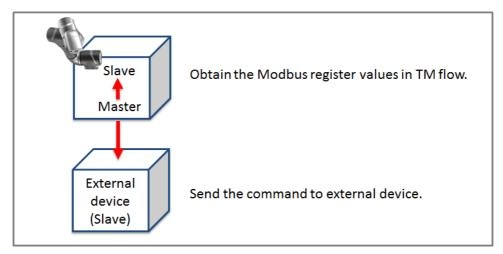
Figure 174: Robot Modbus Protocol
