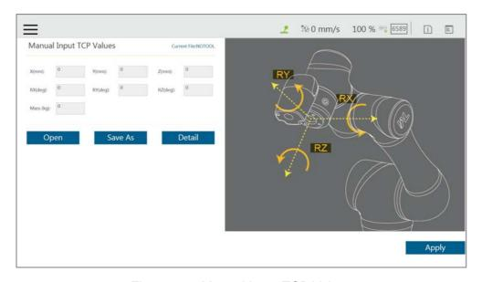
Figure 114: Manual Input TCP Values
