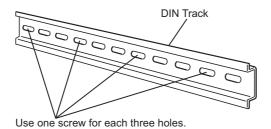
• Using an NS 35/7,5 PERF or NS 35/15 PERF DIN Track
